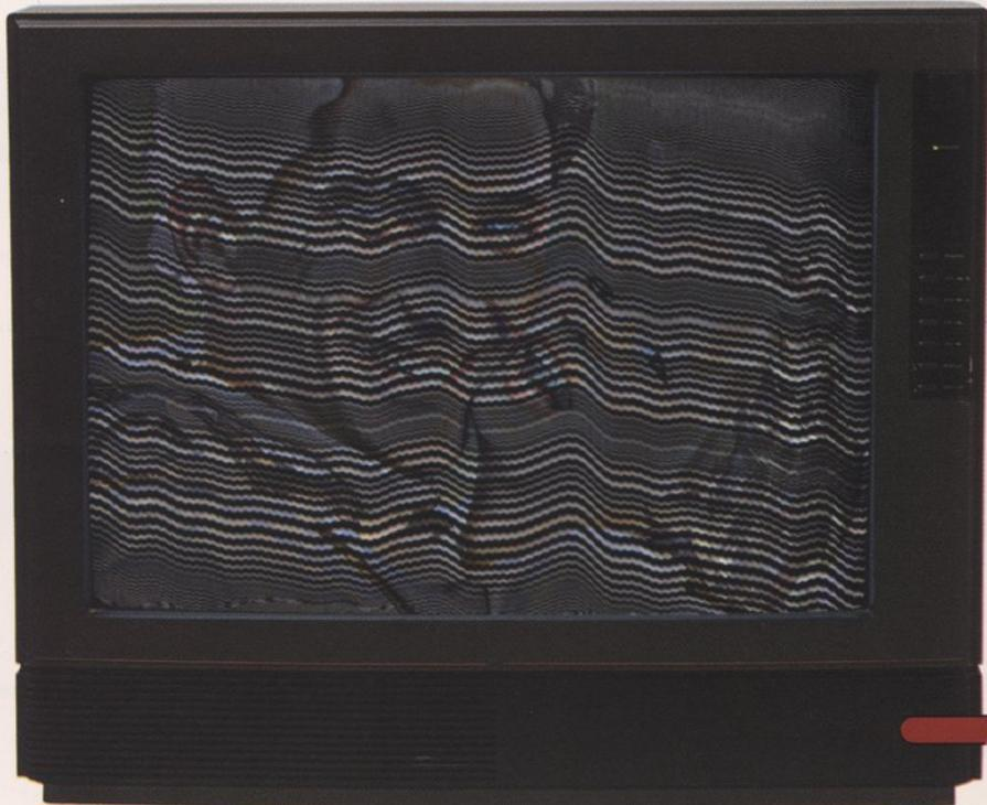
*Alteração da imagem provocada por radiações dos osciladores locais dos receptores.*
