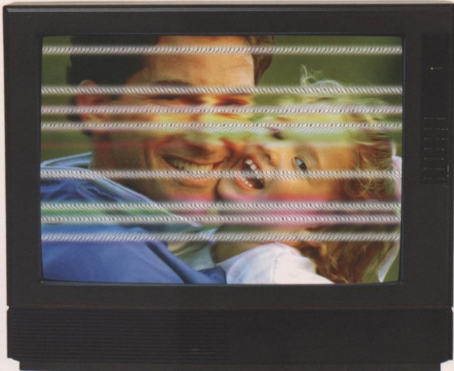
*Alteração da imagem provocada por funcionamento anómalo de estação emissora.*
