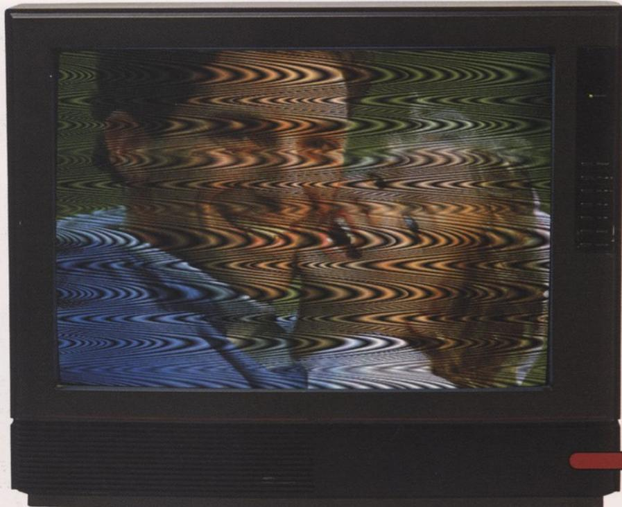
*Alteração da imagem devido a deficiente funcionamento do amplificador utilizado na instalação.*
