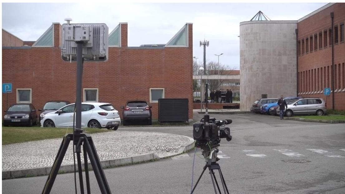
**Figura 37 – eNode-B da Nokia instalado em estrutura portátil e sistema de emissão PMSE.**
