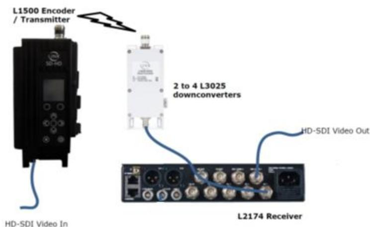
Figura 30 – Diagrama de interligação dos diversos componentes do sistema PMSE (Fonte: VISLINK).
