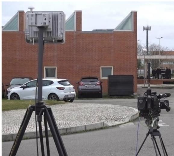
Figura 61 – Posicionamento do emissor PMSE junto ao eNode-B LTE, na subzona Z3.
