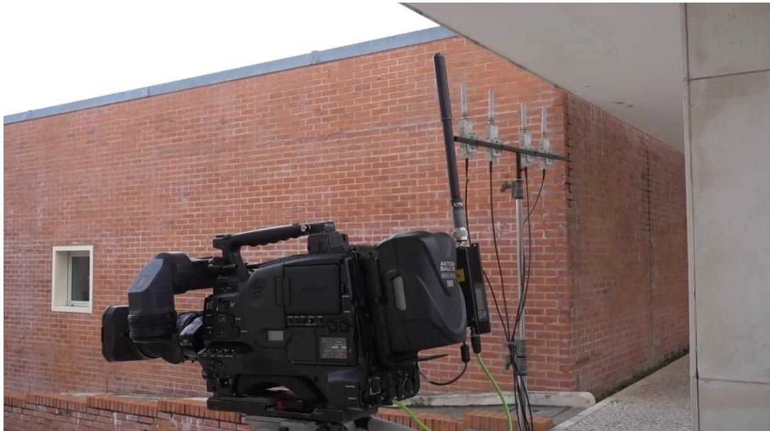
**Figura 38 – Sistema de emissão e receção PMSE (teste da ligação de vídeo).**
