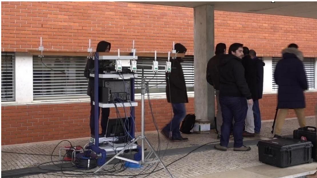
Figura 42 – Teste de interferência do *downlink* LTE TDD na receção de PMSE.
