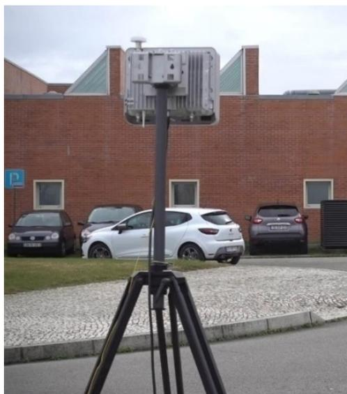
Figura 48 – Estrutura de suporte do eNode-B controlável pelo sistema de gestão e controlo LSA.
