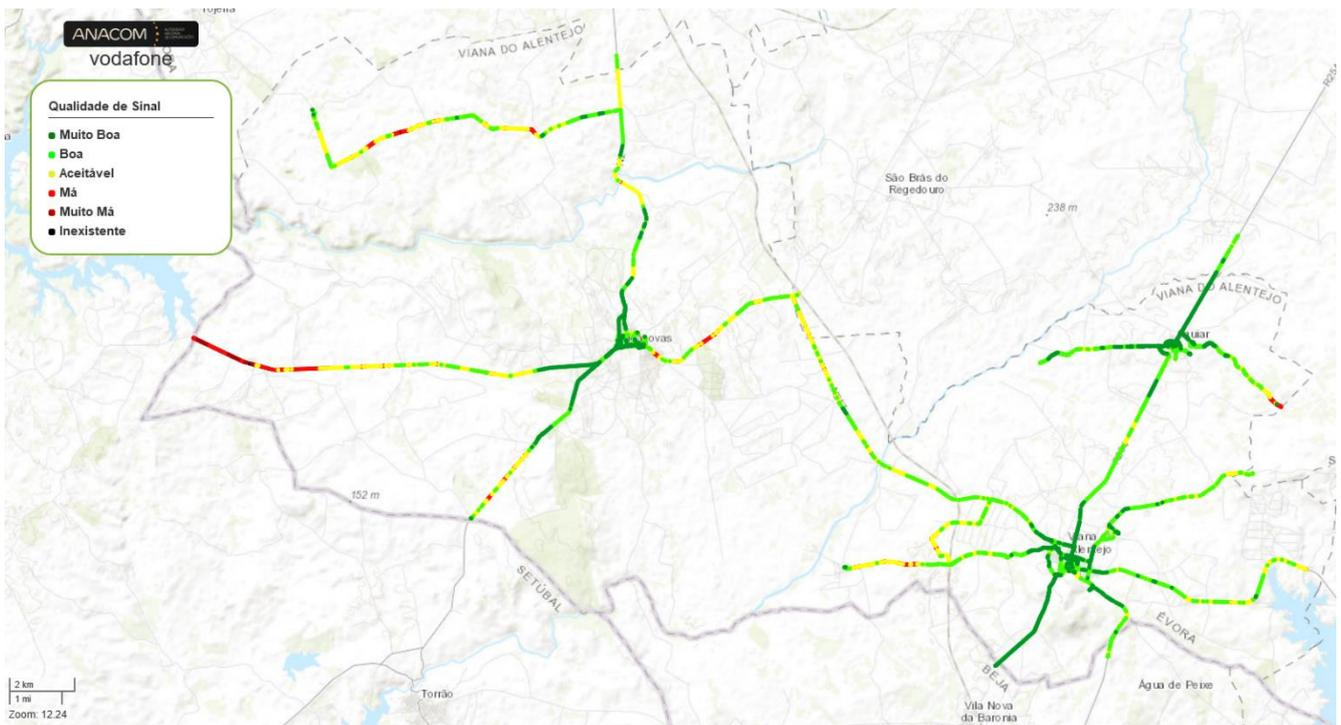
Na Figura 15 foi identificado, para cada ponto geográfico, o melhor nível de sinal entre os três operadores analisados. Desta forma, pretende-se realçar que, da totalidade dos testes realizados, caso estivesse disponível o *roaming* nacional, teríamos uma cobertura agregada de maior qualidade ascendendo aos 95,7% (níveis de qualidade “Muito Boa”, “Boa” e “Aceitável”).
