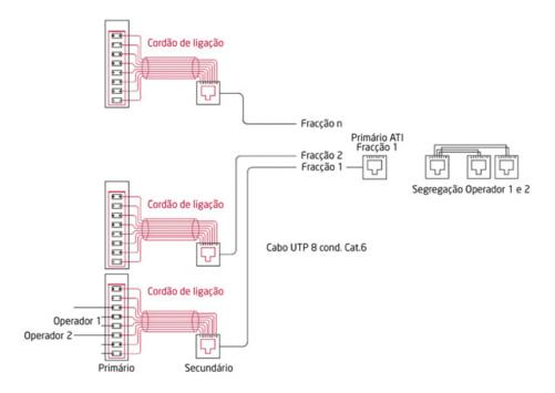
FIGURA 80: Esquema exemplo de RG-PC
