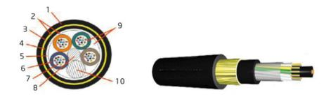
Bainha exterior Z. Fio de rasgar 3. Elemento de tracção 4. Bainha interior 5. Cableamento 6. Tubo Loose 7. Fibra óptica 8. Tensor central (dieléctrico) 9. Geleia 10. Enchimento
