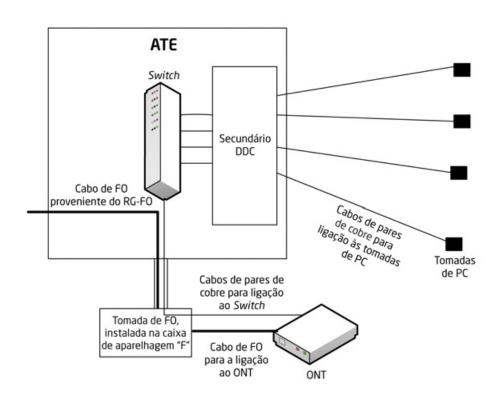
FIGURA 97: Exemplo de distribuição do sinal num fogo com infra-estrutura ITED
