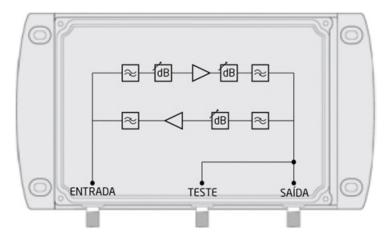
• Como ponto de Recepção e Tratamento de Sinais, trata-se de uma Central cujos sinais de saída servirão pelo menos uma Central de Grau inferior (3) instalada a jusante. Os sinais passarão assim, pelo menos, por dois sistemas de amplificação antes de atingirem os pontos terminais da rede - Tomadas Coaxiais.
