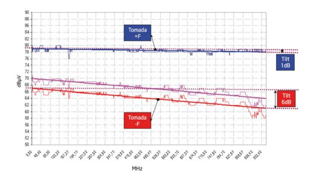
A zona entre as curvas das tomadas +F e -F é a zona de funcionamento estimada para a rede de distribuição, tal como ilustra a figura seguinte. As curvas de registo respeitantes às restantes tomadas da fracção, onde se inclui a tomada em falha, devem estar dentro dos limites assinalados acima, apresentando uma tendência idêntica à da figura seguinte.
