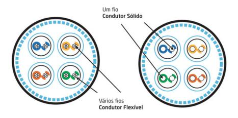
Os cabos do tipo Sólido serão utilizados em ligações permanentes e longas. Não está aconselhada a utilização de cabos deste tipo em Cordões, onde se exige flexibilidade e frequência no manuseamento, e onde não se devem atingir comprimentos superiores a 5 metros.
