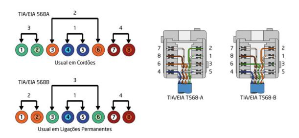
Para além das recomendações do fabricante, que devem ser tomadas em consideração, o instalador deve tomar todas as precauções de forma a nunca destorcer os pares mais do que o necessário, de forma a compatibilizar o cabo com o conector. Destorcer os pares mais do que o necessário, mesmo que de seguida se proceda a um entrançar do par, não é uma acção correcta. O procedimento a seguir deve ser o efectuar um corte no cabo e proceder de novo à preparação dos condutores para a cravação.
