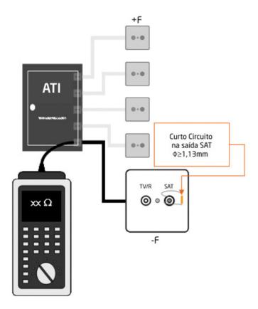
Este ensaio poderá ser realizado em qualquer troço de cabo coaxial, tanto da infra-estrutura colectiva como da individual, procurando troços de comprimento superior a 10m.
