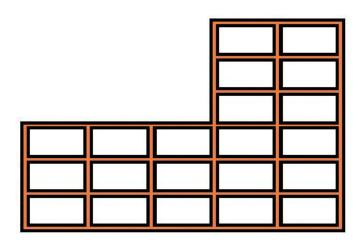
O eléctrodo do tipo fundação é constituído por troços de metal condutor embebidos no cimento das fundações do edifício. Uma das vantagens deste tipo de eléctrodo é que as partes metálicas não necessitam de uma protecção adicional anticorrosiva. Este tipo de eléctrodo é considerado como uma solução muito prática para o sistema de terras do edifício.
