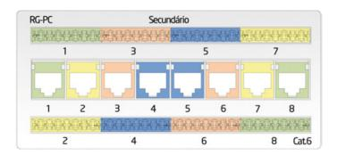
FIGURA 59: Exemplo de unidades modulares em par de cobre, categoria 6
