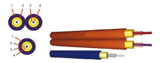
1. Bainha exterior 2. Elemento de tracção 3. Bainha interior 4. Fibra óptica
