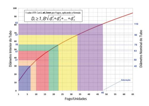
FIGURA 75: Diâmetro da coluna CC em função do número de fogos
