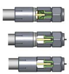
Para ligações tipo "F" que requeiram alguma alteração ou manuseio pontual (nos ATE e nos ATI, por exemplo), possibilita-se a utilização da conexão "F" macho rápido. Trata-se de um conector angular, normalmente a 90°, cuja cápsula da extremidade possui um sistema de mola em vez da típica rosca do "F", tornando assim o acto de ligação mais prático de desenvolver.
