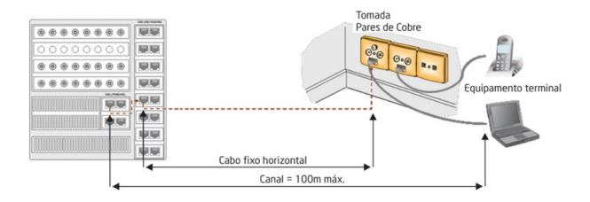
**B** - Apresenta um canal contendo uma interligação, uma interligação adicional e a Tomada de Telecomunicações (TT). Neste caso o ATI liga directamente à tomada; no entanto existe uma interligação intermédia no próprio ATI. O canal inclui cordões de ATI e cordões de tomada. Sejam cordões ou pontes, os tratamentos são idênticos.
