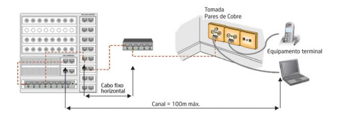
A fim de harmonizar os cabos a utilizar, cordões, cabos de pontos de consolidação, pontes e cordões de equipamentos de diferentes atenuações, o comprimento dos cabos usados num canal são determinados pelas equações da tabela das ligações permanentes horizontais.
