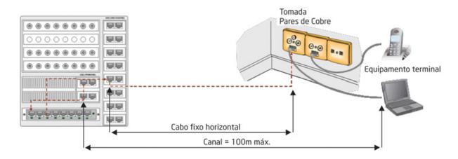
**C** - Apresenta um canal contendo uma interligação, um ponto de consolidação e a TT. Neste caso o ATI liga directamente ao ponto de consolidação e daí à tomada. O canal inclui cordões de ATI e cordões de tomada. Sejam cordões ou pontes, os tratamentos são idênticos. Em adição aos cordões, esta figura apresenta um cabo no ponto de consolidação. As perdas de inserção deste cabo podem diferir das dos cabos de ligação permanente e dos flexíveis.
