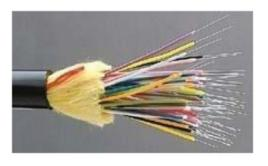
**Loose Tube (Solta)** - As fibras são alojadas dentro de um tubo cujo diâmetro é muito superior ao das fibras (*loose buffers*). Isto, por si só, isola as fibras das tensões externas presentes no cabo, tais como tracção, flexão ou variações de temperatura. Dentro deste tubo é aplicado um gel derivado de petróleo, com características de isolamento relativamente a humidades externas.
