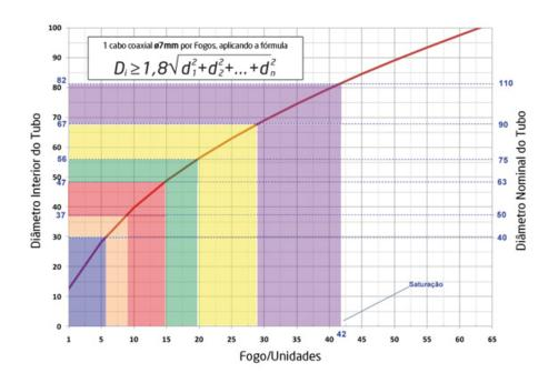
FIGURA 76: Diâmetro da coluna FO em função do número de fogos
