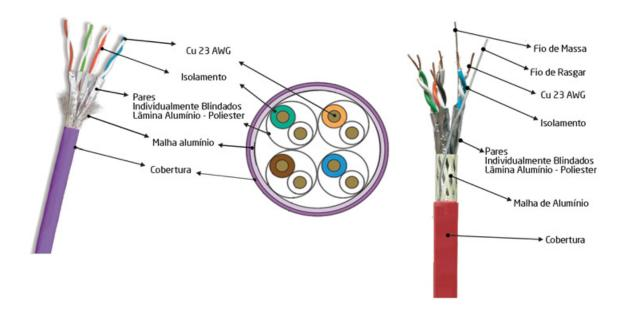
FIGURA 7: Exemplo de cabo UTP, Cat. 6
