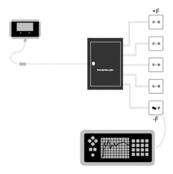
Os valores para as tomadas +F e -F, medidos para as bandas 5 aos 862MHz e 950 aos 2150MHz, serão registados no medidor de campo, conforme ilustra a figura seguinte:
