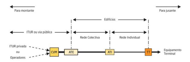
A correcta interligação dos PD existentes num edifício, pela cablagem, permite a passagem e a distribuição dos sinais provenientes dos operadores, bem como a implementação de redes de dados geridas pelos proprietários e as administrações dos edifícios.
