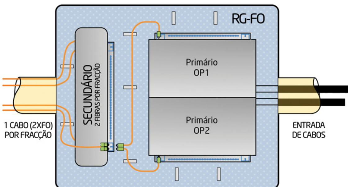
**FIGURA 63: Exemplos de caixas tipo para o RG-FO e respectivas interligações**
