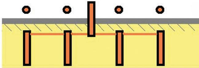
Os eléctrodos do tipo malha são constituídos por um conjunto de varetas ou fitas, colocadas horizontalmente no solo. Com a utilização das fitas obtém-se uma maior superfície de contacto com a terra, conseguindo-se deste modo uma terra mais adequada às altas frequências. Este tipo de eléctrodos favorece a distribuição de potencial, no entanto, é mais susceptível às mudanças da constituição do solo.
