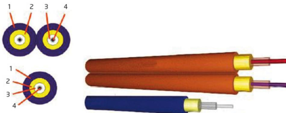
1. Bainha exterior 2. Elemento de tracção 3. Bainha interior 4. Fibra óptica
