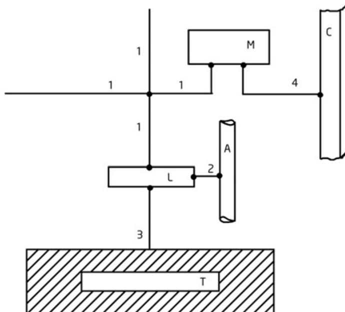
1. Condutor de protecção 2. Condutor da ligação equipotencial principal 3. Condutor de terra 4. Condutor de equipotencialidade
