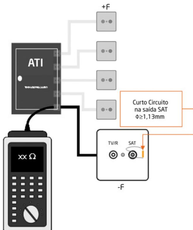
Este ensaio poderá ser realizado em qualquer trecho de cabo coaxial, tanto da infra-estrutura colectiva como da individual, procurando treços de comprimento superior a 10m.
