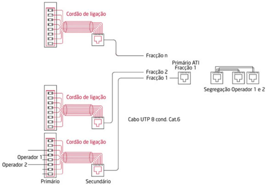
FIGURA 80: Esquema exemplo de RG-PC
