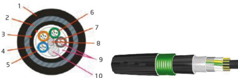
1. Bainha exterior 2. Fita de aço corrugado 3. Fio de rasgar 4. Bainha interior 5. Cableamento 6. Tubo *Loose* 7. Fibra óptica 8. Tensor central (dieléctrico) 9. Geleia 10. Enchimento
