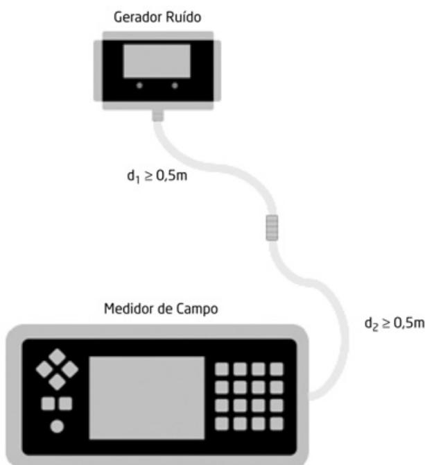
2. Após ser efectuada esta calibração, o gerador de ruído será ligado ao RG-CC/CATV, sendo o medidor colocado numa TT. A atenuação nas diversas frequências de teste será a diferença entre o registo de referência e o valor medido nas TT, através do medidor de campo. Os valores são obrigatoriamente registados no REF.
