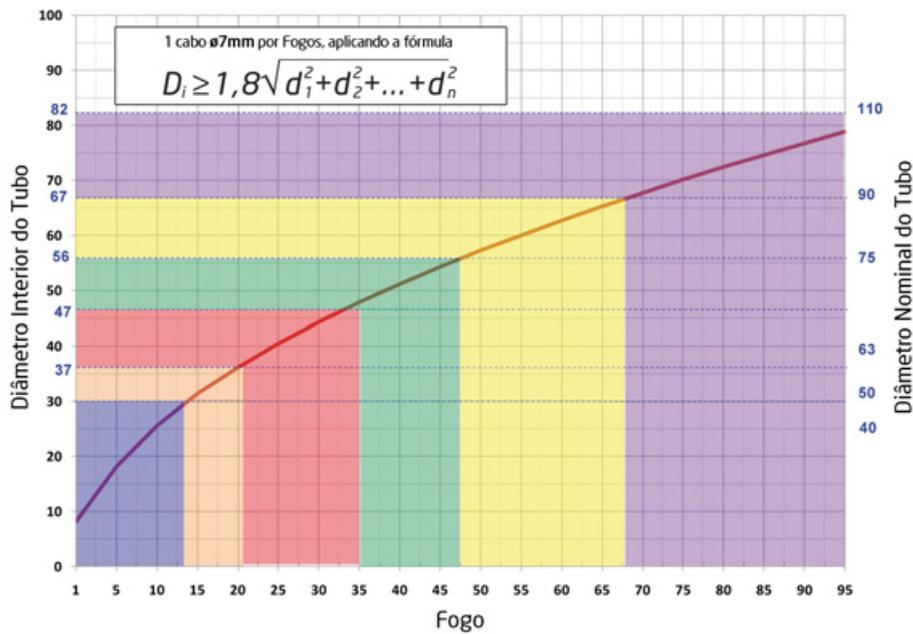
FIGURA 77: Capacidade das calhas por compartimento, na Coluna Montante (uma coluna)
