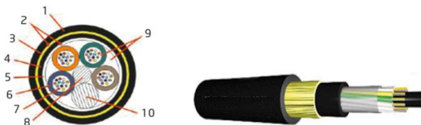
1. Bainha exterior 2. Fio de rasgar 3. Elemento de tracção 4. Bainha interior 5. Cableamento 6. Tubo Loose 7. Fibra óptica 8. Tensor central (dielétrico) 9. Geleia 10. Enchimento
