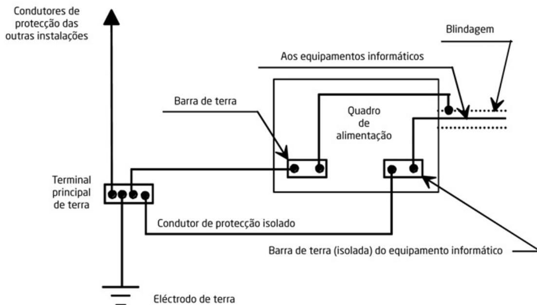
De acordo com o indicado na secção 4.1.3.1, das RT, não é permitida a ligação a eléctrodos de terra diferentes de massas simultaneamente acessíveis. Esta condição implica que, num determinado edifício, todas as instalações devem estar ligadas ao mesmo sistema de terras e equipotencializadas.
