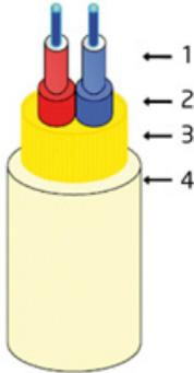
1. Fibra Óptica (ITU-T G.657A) 2. Diâmetro 0,9mm 3. Envolvente de aramida 4. Bainha retardante à propagação de chama
