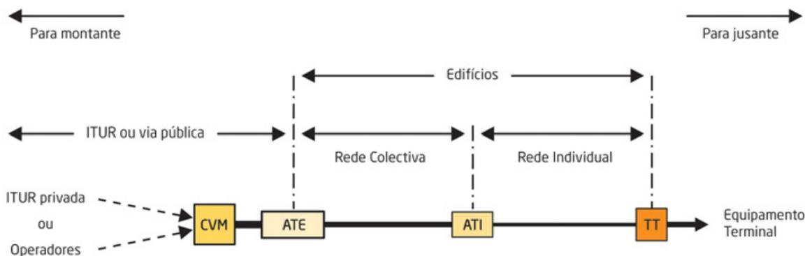
A correcta interligação dos PD existentes num edifício, pela cablagem, permite a passagem e a distribuição dos sinais provenientes dos operadores, bem como a implementação de redes de dados geridas pelos proprietários e as administrações dos edifícios.
