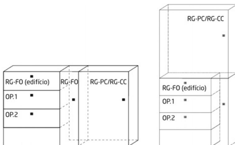
O ATE superior contém pelo menos um RG-CC, que garante a recepção e distribuição de sinais de radiodifusão sonora e televisiva. Neste caso prevê-se a existência de um barramento suplementar de terras, que será interligado ao Barramento Geral de Terras das ITED (BGT). É obrigatória a existência de energia eléctrica no ATE superior.
