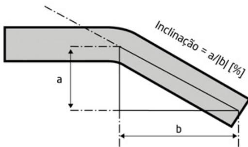
FIGURA 101: Raio de curvatura
