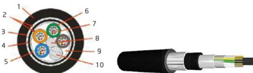
1. Bainha exterior 2. Fio de rasgar 3. Protecção contra roedores 4. Bainha interior 5. Cableamento 6. Tubo *Loose* 7. Fibra óptica 8. Tensor central (dieléctrico) 9. Geleia 10. Enchimento
