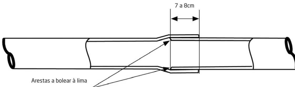
**TUBO FRP** - A união destes tubos pode ser efectuada por dois processos:
