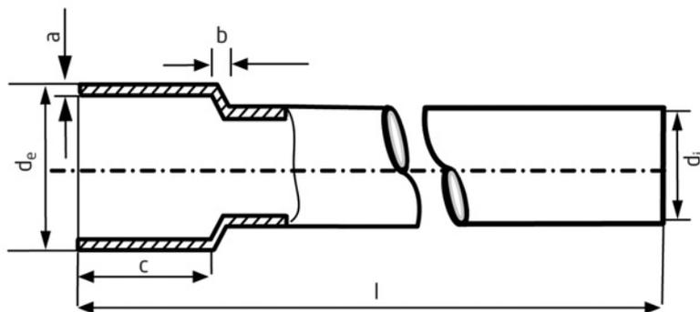
**TUBO FRP** - tubo rígido com parede dupla, sendo a interior lisa e a exterior anelada, podendo ter, ou não, uma extremidade alargada para permitir a união por abocardamento. O polímero é reforçado com fibras de carbono ou de vidro.
