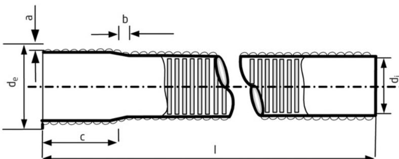
**TUBO PEAD** - tubo rígido com paredes exteriores lisas.
