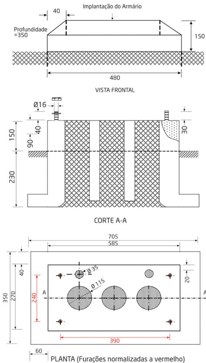
Para as ITUR públicas, os pedestais devem ter dimensões adequadas aos armários, ficando cerca de 150mm acima da superfície, e possuírem ligação à CV, com pelo menos 3 tubos de 90mm e respectivas guias.
