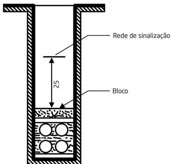
FIGURA 37: Desenhos esquemáticos de blocos de tubagem no interior de uma vala técnica
