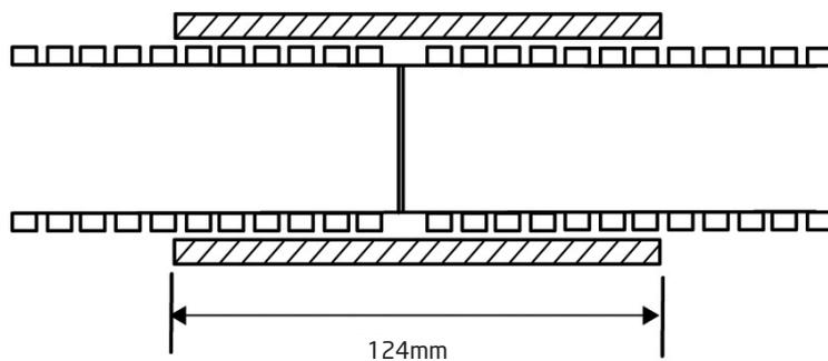
**TUBO PEAD** - Os tubos de polietileno de alta densidade devem ser ligados através de acessórios electro-soldáveis. As ligações electro-soldáveis são caracterizadas pelo facto dos acessórios, também em PEAD, possuírem resistências incorporadas que, por efeito de joule, fundem as camadas de material do acessório e dos tubos.
