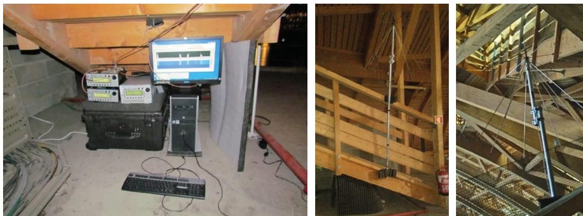
**FIGURA 3 – Estação remota de monitorização instalada na Altice Arena, com pormenor da antena em utilização**
