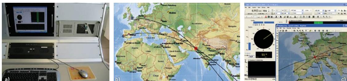
**FIGURA 8 – Interfaces de utilizador do radiogoniómetro de onda longa, onda média e onda curta. a) Posição de controlo. b) Exemplo de localização de uma fonte de emissão radioelétrica, por triangulação. c) Interface gráfica do utilizador**
