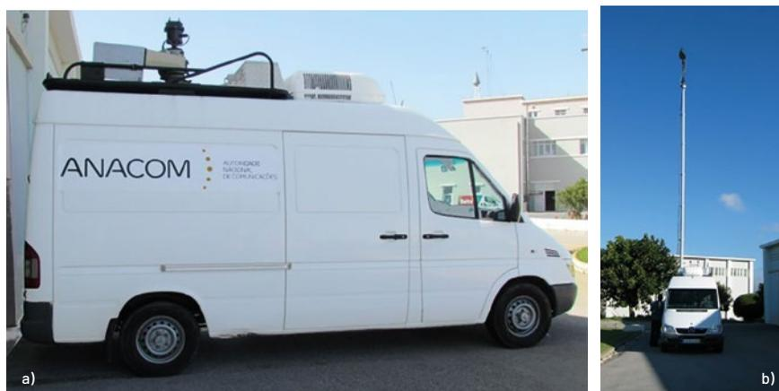
**FIGURA 16 – Meios móveis de monitorização e controlo do espectro radioelétrico. a) Estação móvel de monitorização. b) Pormenor do mastro hidráulico-pneumático, de 12 m, em utilização na estação móvel**
