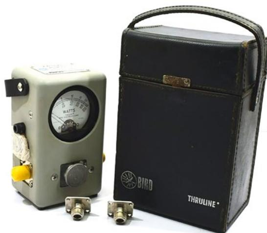
**FIGURA 8 – Equipamento normalmente utilizado para medição de potência**
