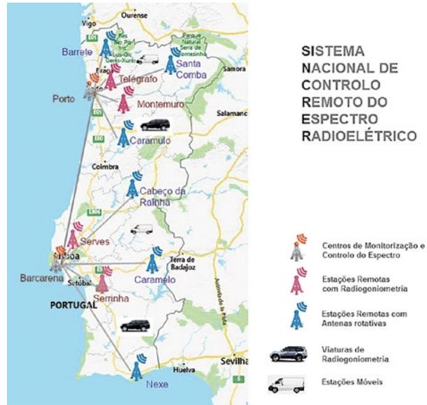
**FIGURA 13 – Rede de estações remotas fixas de monitorização do espectro – SINCRER**
