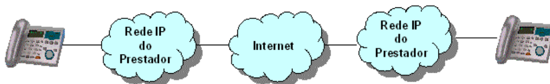
Figura 5 – Configuração típica de uma interligação IP-IP
