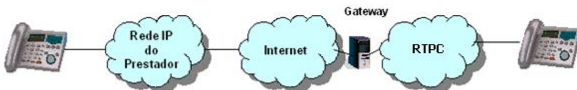
Figura 4 – Configuração típica de uma interligação IP-RTPC ou RTPC-IP
