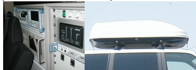
Fig. 4. Radiogoniómetro Móvel de V/UHF com as antenas dissimuladas.
