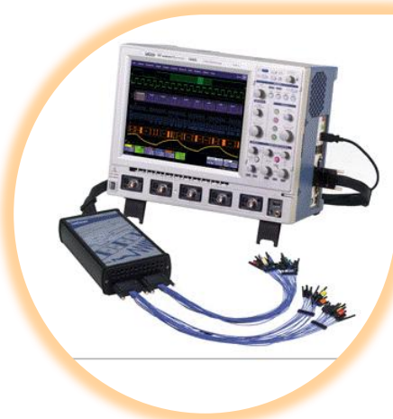
Figura 2 – Mixed-Signal Oscilloscope disponibilizado por uma empresa de instrumentação.
