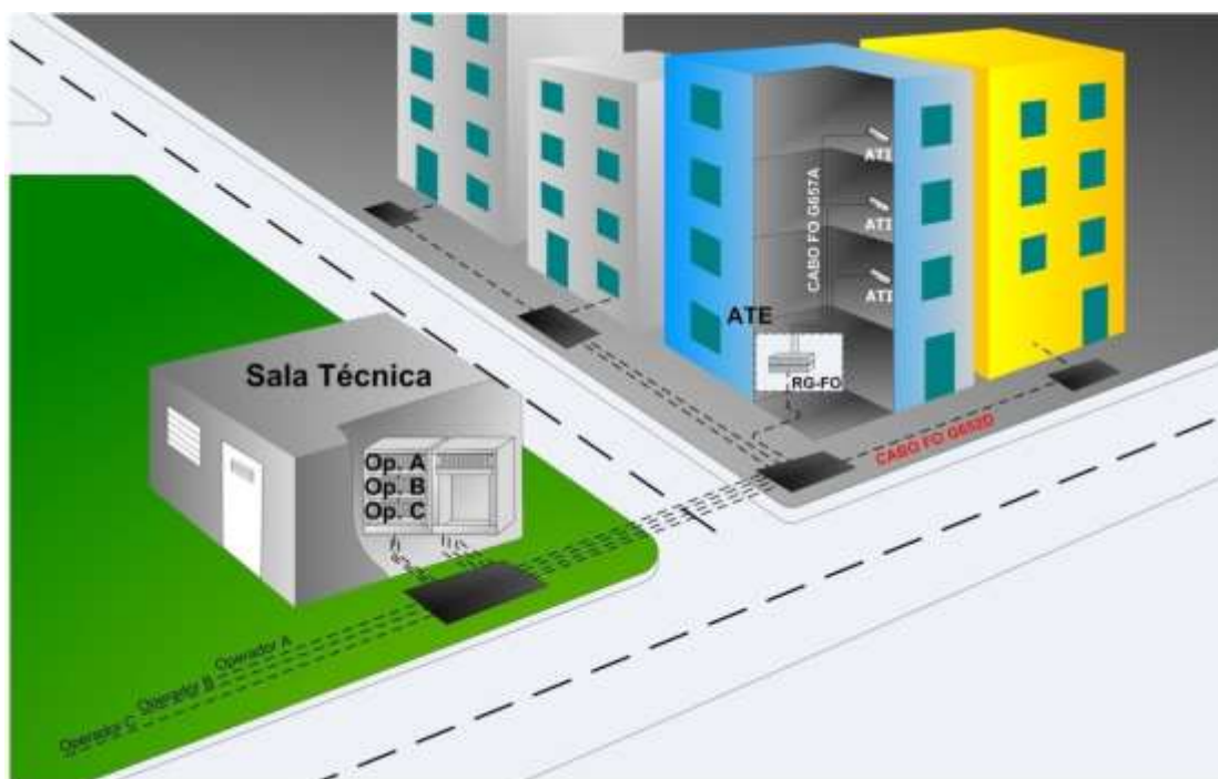
4.23 - Diagrama esquemático de uma solução para distribuição em FO numa ITUR privada
