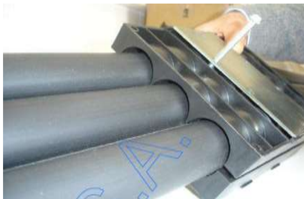
3.8 - União de tritubo através de acessórios electro-soldáveis
