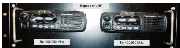
Figura 50. Repetidor de radiocomunicações do Serviço Móvel Terrestre.
