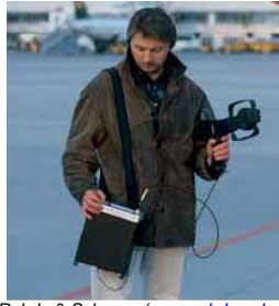
Figura 46. Radiogoniometria recorrendo a um receptor e a uma antena directiva.
