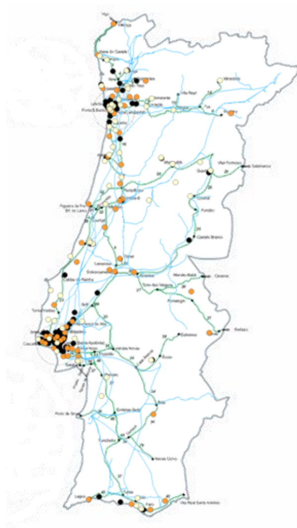
Figura 12 - Infra-estruturas de transporte da ReferTelecom 207 e da REN (ligações a azul e verde) e centrais locais da PTC onde existem apenas um (amarela), dois (laranja) ou três (preta) operadores co-instalados com transmissão própria 208
